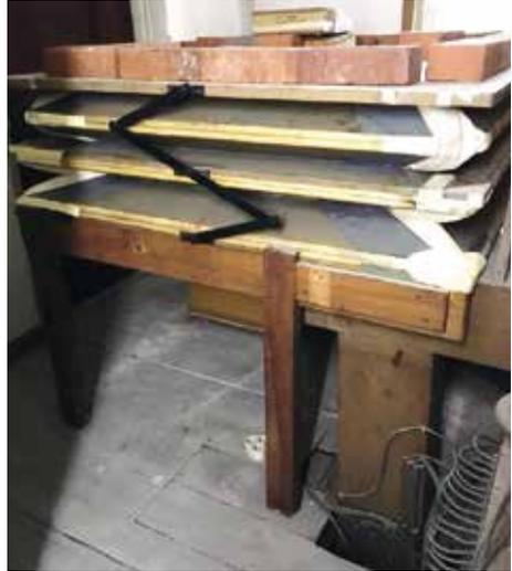
Links: Verzierte Schwellbretter aus St. Marien (analog Paderborner Dom); kurioserweise ist die Verzierung aus dem Kirchraum nicht sichtbar, weil hinter den Metallgittern des Pfeifenprospekts positioniert. Rechts: Magazinbalg der oberen Orgel, bereits mehrfach provisorisch ausgebessert.
